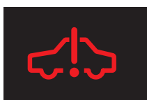
ハイブリッドシステム 異常警告灯
